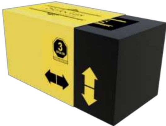
Ilustración 63 Perspectiva mostrando el deslizamiento de la cinta de protección, (fuente propia 2022).
