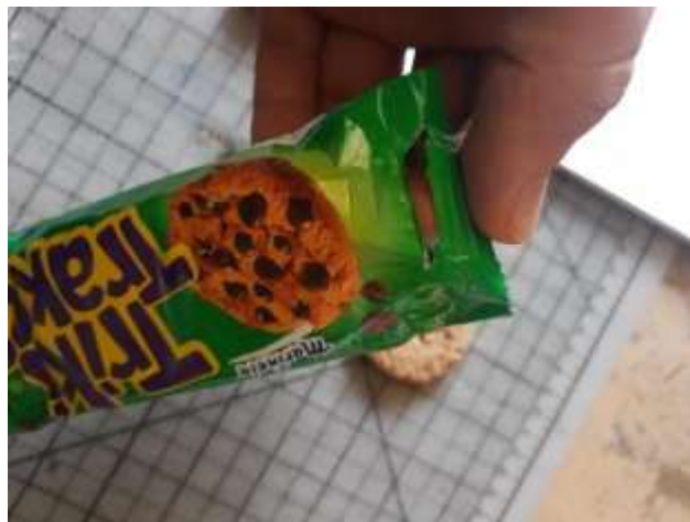
Ilustración 13 Ruptura del empaque (fuente propia 2021)
